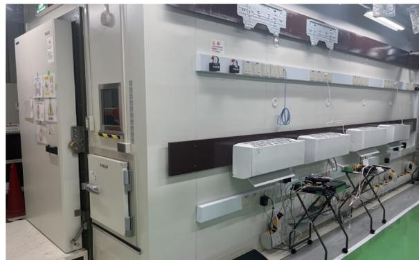
家庭用エアコンの動作の信頼性を評価するための暖房運転耐久試験設備です。試験室内は-50°C~0°Cまでの温度制御が可能で、最大5,000時間までの連続運転が可能な凍上防止対策を施した試験室です。
