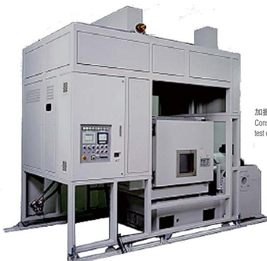
加振機用恒温恒湿槽
